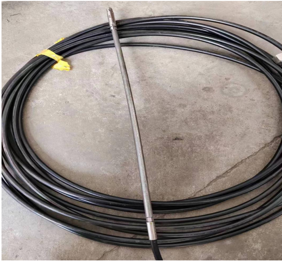
清洗设备之一（该设备由管路清洗自旋转喷头、软管、枪杆组成）
